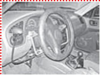
**Изготовление и установка устройств ручного управления автомобилем на все марки отечественных и зарубежных автомобилей**
